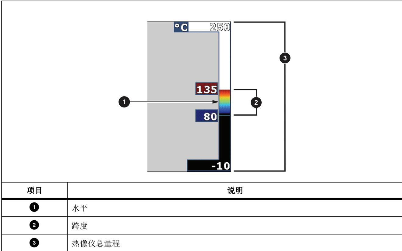
在自动水平 / 跨度模式下，热像仪根据**量程**内设置的温度来设置**水平 / 跨度**。
