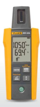
高精度单晶太阳能传感器 瞬时辐照测量能力高达 1400 W/m²
