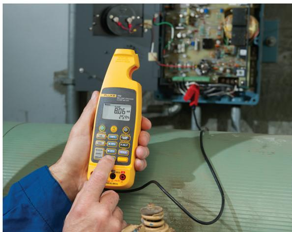
Fluke 773 的钳头部分是可拆卸的，通过外部电缆连接到测试工具的机身。
