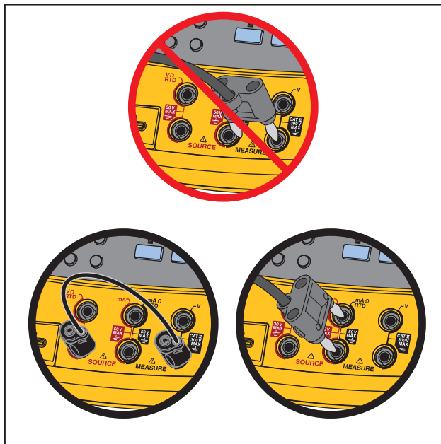
图 16. 正确的跨接器使用
