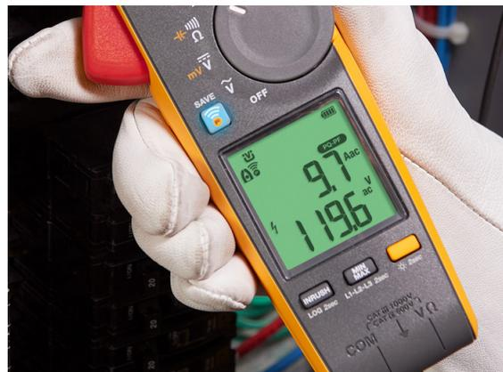
Fluke 378 FC 包含一项电能质量测试功能，PQ图标能够快速指示是否存在谐波或功率因数问题。
